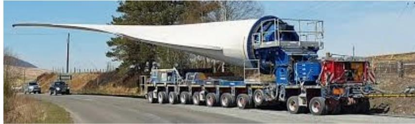
شكل رقم 4-8: شاحنات رفع الشفرات التي تُستخدم في التضاريس الجبلية للتنقل عبر المنحنيات الضيقة
